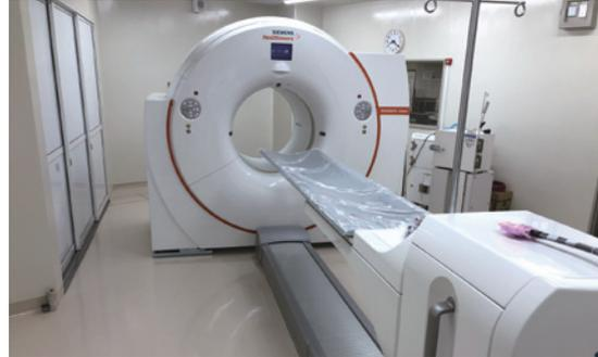
検出器にシリコン光電子増倍素子(SiPM)を用いており、従来の装置と比較し、体内に投与されたPET薬剤の位置を精度よく演算することが可能です。また検出器の大きさを小さくすることによって、空間分解能の向上が期待できます。従来の装置と比較し、高画質なPET画像を提供することが可能となりました。
