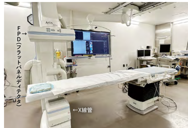
A棟にある血管撮像装置。X線は下から照射され、FPDが画像に変換する
