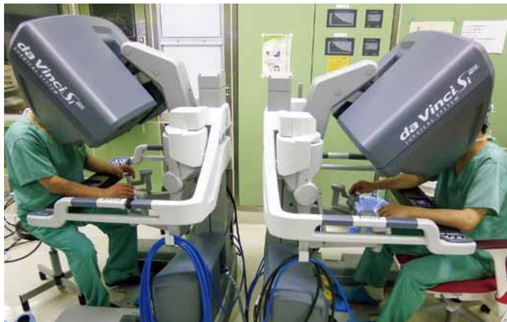
写真 新型ダビンチ・システム： ロボット操作部分が2つあります。
