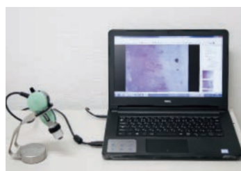
図1 毛細血管顕微鏡 強皮症や皮膚筋炎など膠原病の早期診断に有用な最新機器です。爪の根元の毛細血管の異常が、診断の手がかりとなります。
