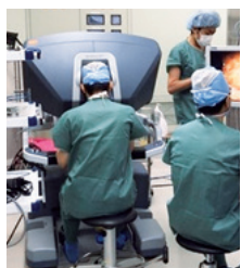
(左)日本内視鏡外科学会 ロボット支援手術プロクター（指導医）認定証 (右)執刀医がサージョンコンソールと呼ばれる操作ボックスの中で3D内視鏡画像を見ながら操作
