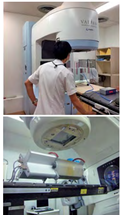
高精度放射線治療の安全な実施に欠かせない放射線治療装置の精度管理
