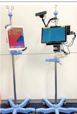
写真⑤ NICU・GCUの赤ちゃん用のシステム(Osaka-N system)タブレットからカメラとバーコードリーダーが出ています。写真⑥ 成人用のシステム(Osaka-A system)タブレットだけのシンプルな作りです。手に持たなくても、支柱に固定しました。
