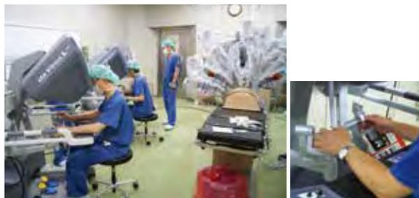
ケーブルでつながった操作台から3次元の立体的な画像を見ながら手元のコントローラーを使って患部を切除したり縫合したりする
