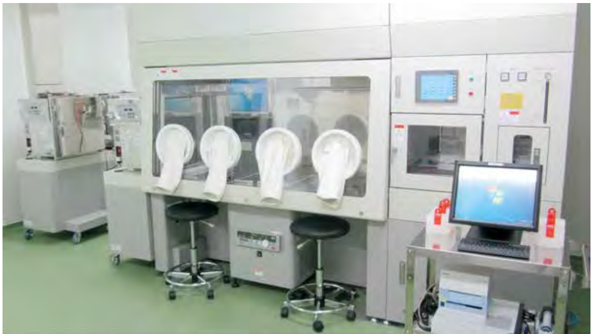
▲細胞調製ユニット内のアイソレータ
