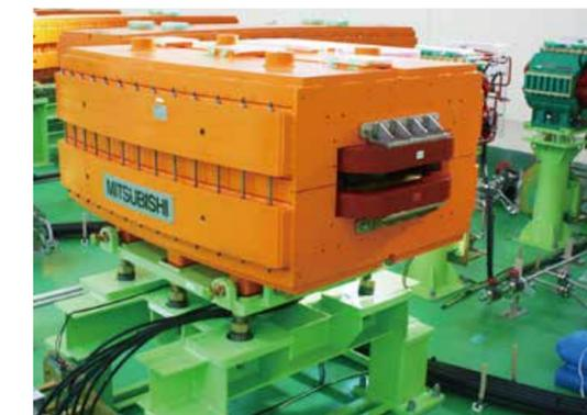
写真：シンクロトロン用偏向電磁石
