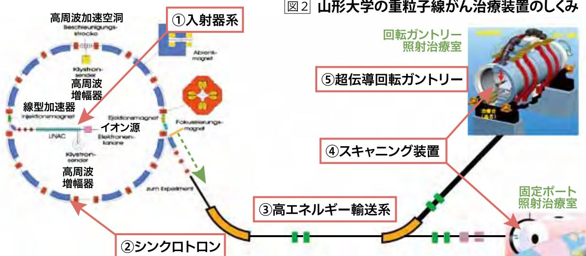
重粒子線がん治療装置は、図2にあるように、①の入射器系で炭素のイオン（重粒子）を作り出し、②のシンクロトロン（加速器）で光速の70%近くまで重粒子線を加速し、③の高エネルギー輸送系を経て治療室まで重粒子線を輸送し、治療室内にある④のスキヤニング装置により患者さんのがんに重粒子線
