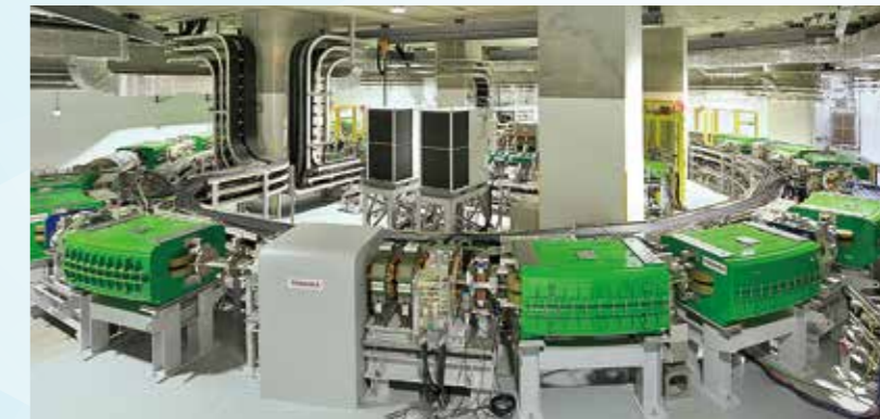
この加速器によって光の速さの70%近くまで加速させた炭素イオン(重粒子)を患部にピンポイントで照射
